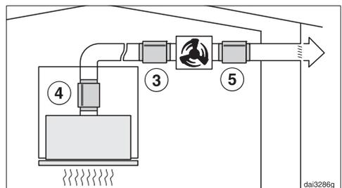
Bei Betrieb mit einem externen Gebläse können die Gebläsegeräusche nach außen und in der Küche minimiert werden. Wenn der Schalldämpfer vor dem exter-
